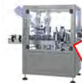
OMB / Z-Italia Etikettierer 1.000 Fl/h bis 50.000 Fl/h
