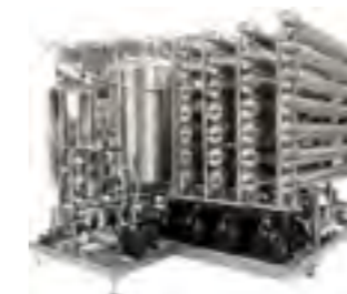
Osmose u. Entalkoholisierung kombinierte Modulbauweise
